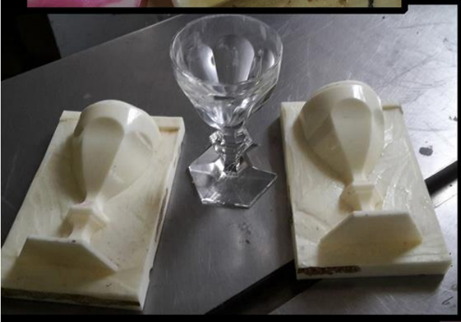
Matrice en résine PU, pour thermoformer les moules de verre à pied. Maison BACCARAT / Paris
