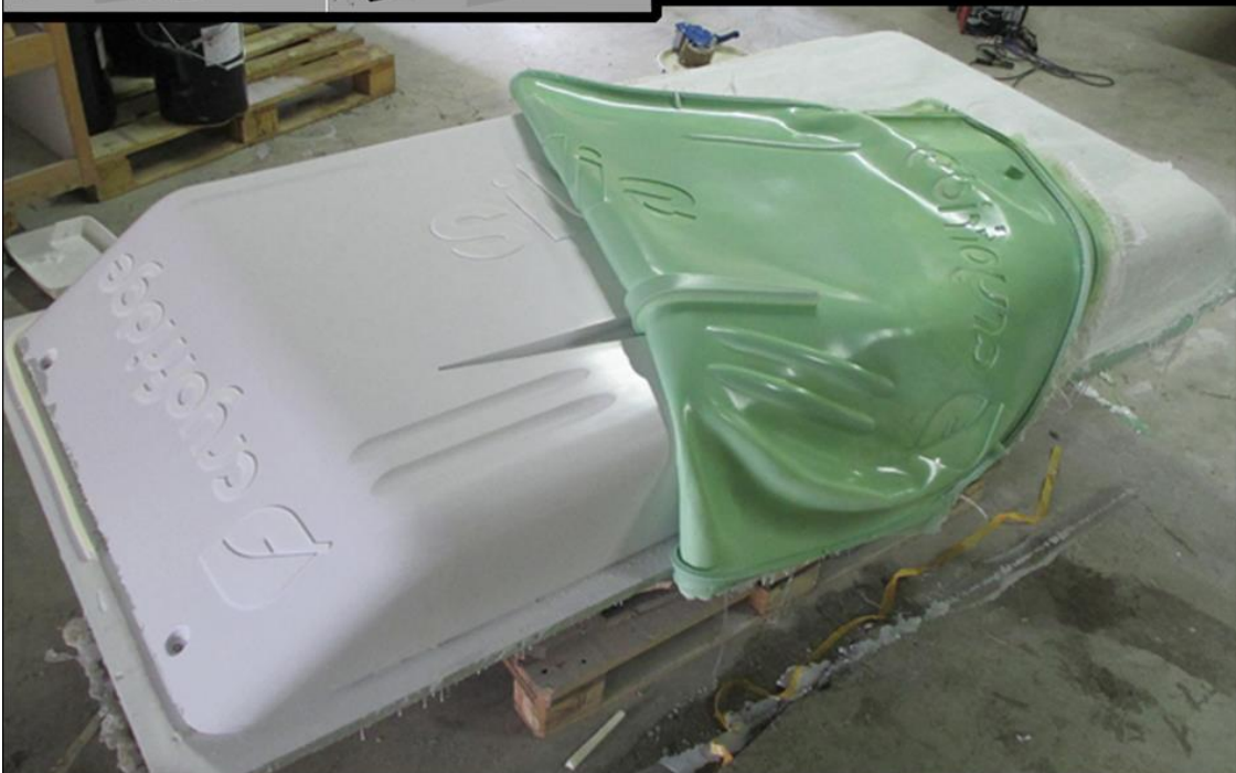
Moule creux sur mesure pour un carrossier industriel. Cache du groupe frigo du camion...
