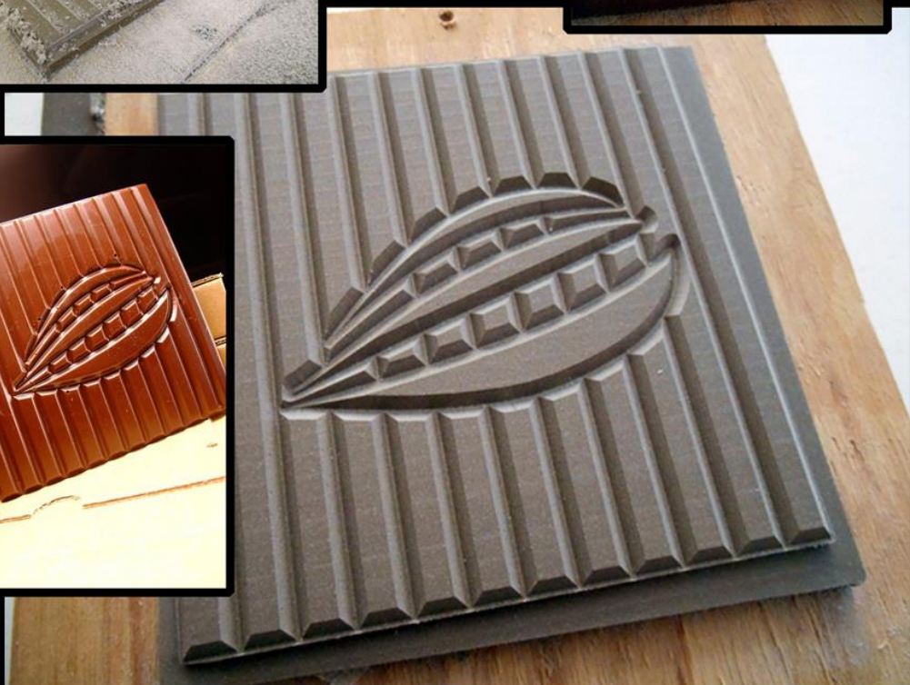
Matrice en résine PU, pour thermoformer les moules des tablettes de chocolat personnalisées.
