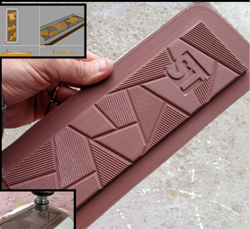
Matrice en résine pour thermoformer un moule à tablette de chocolat pour un pâtissier Californien.
