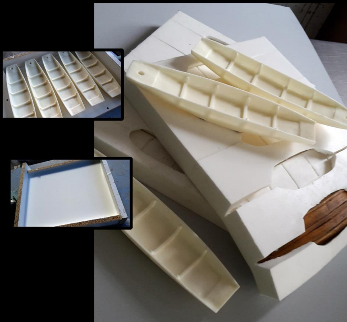
Moules silicone alimentaire pour réaliser des barques de bouchage en chocolat...
