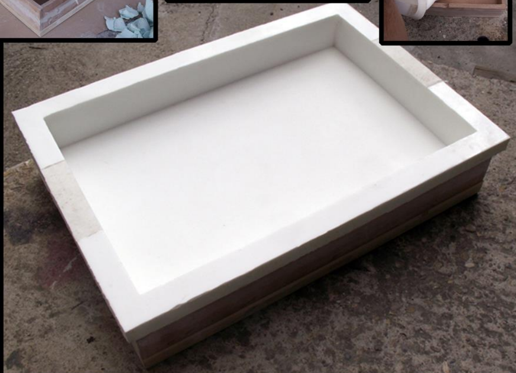
Moule à savon «bio», silicone alimentaire et coque bois.
