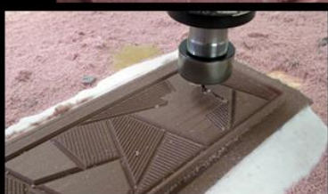
Matrice en résine pour thermoformer un moule à tablette de chocolat pour un pâtissier Californien.
